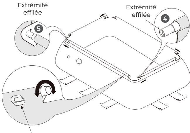
Alignez les trous des tubes 4 et 5 avec les ouvertures des manchons.
