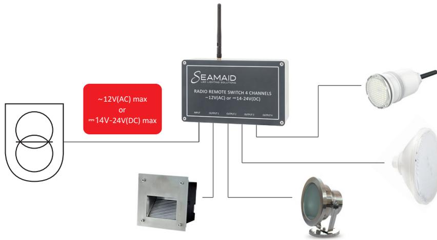
À N'UTILISER QU'AVEC UNE ALIMENTATION OU UN TRANSFORMATEUR ISOLANT DE SÉCURITÉ.
